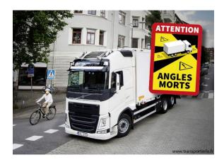
Depuis le 1<sup>er</sup>janvier 2021, une signalisation matérialisant la position des angles morts doit être apposée sur les véhicules de plus de 3,5 tonnes destinés au transport de marchandises ou de personnes circulant sur tout le territoire national.
